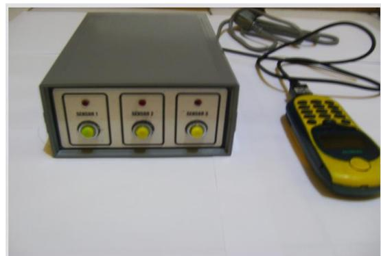
Gbr. 4.9 Tampak Depan alat SMS control dengan indikator 3 lampu dari kiri ke kanan (Level 1, Level 2, Level 3)
